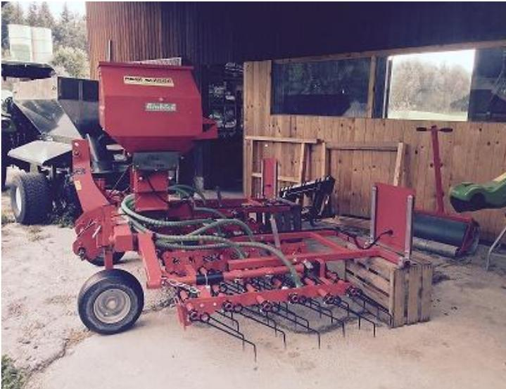
Mit dieser Maschine werden die Rough vertikutiert , und in einem Arbeitsgang die kahlen Stellen neu eingesät. Jetzt braucht es nur noch Wasser.....
